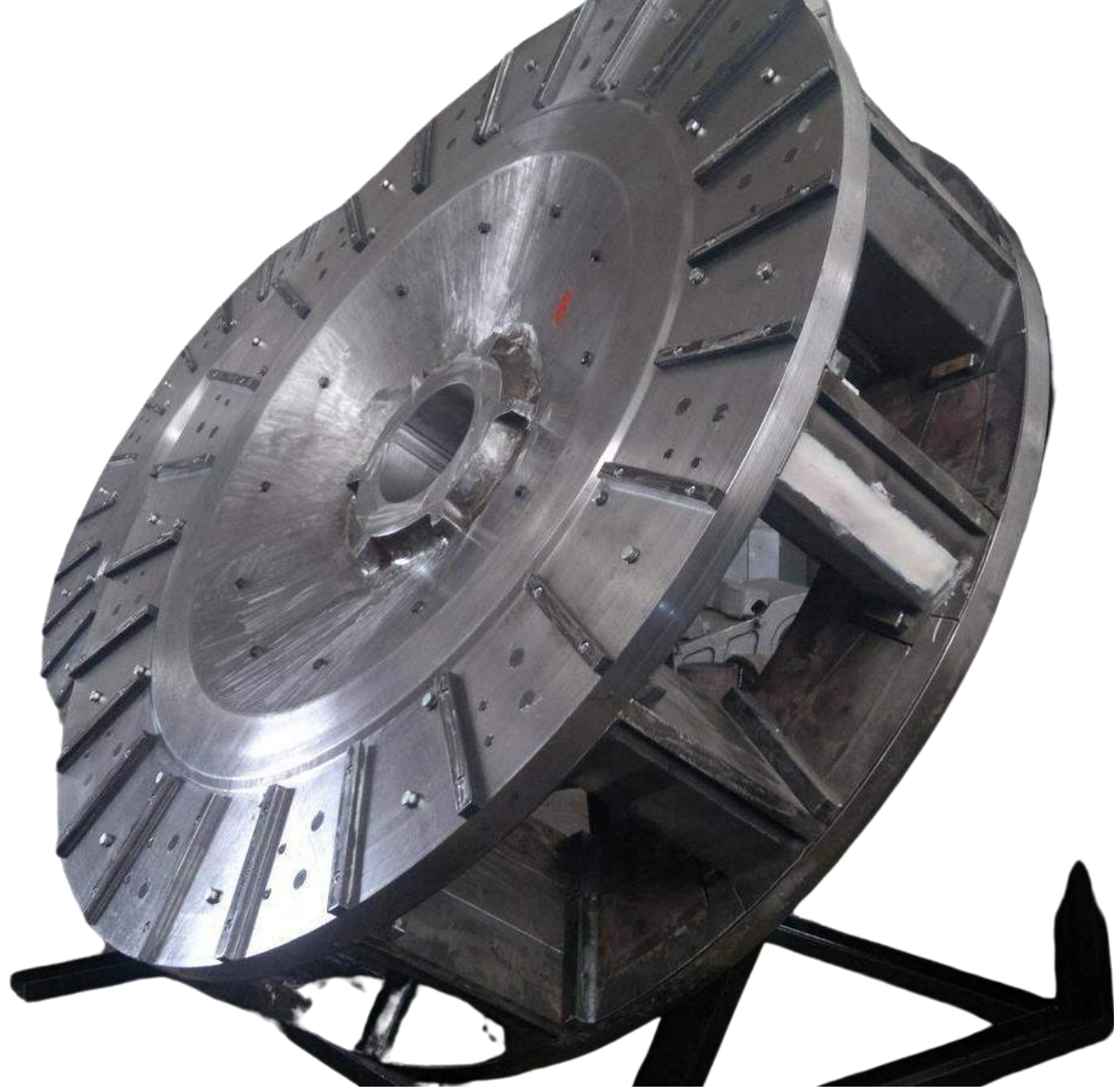
COAL MILL ROTOR ASSEMBLY KÖMÜR DEĞİRMENİ ROTORU
